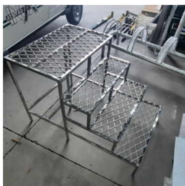
Plataforma de acesso a Equipamentos
